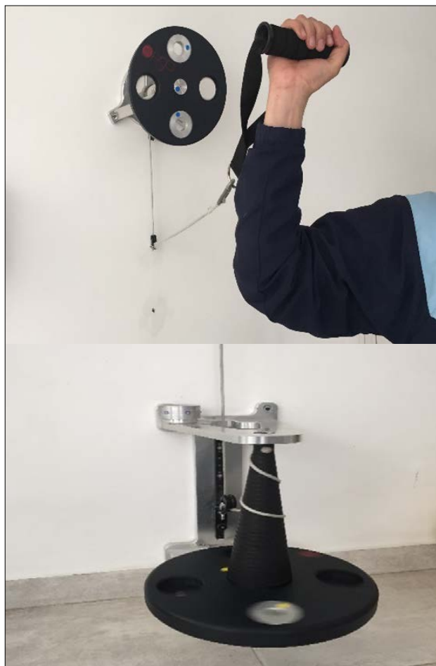
Figura 3 Polea de radio fijo (arriba) y polea cónica isoinercial (abajo).
