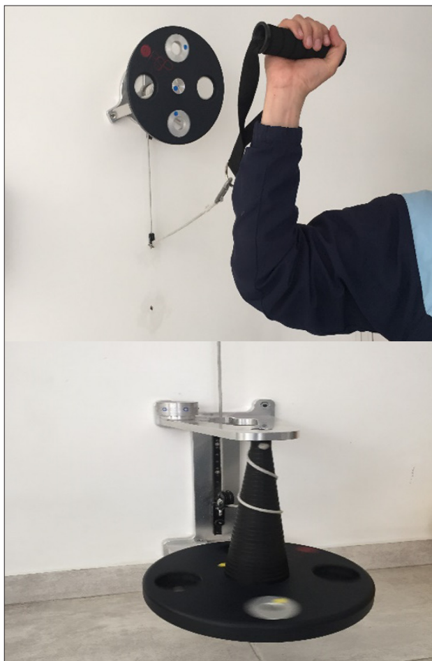
Figura 3 Polea de radio fijo (arriba) y polea cónica isoinercial (abajo).
